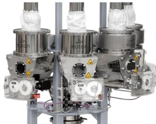
Sencilla sustitución de los dosificadores de tornillo sin fin y las cajas de cambio
