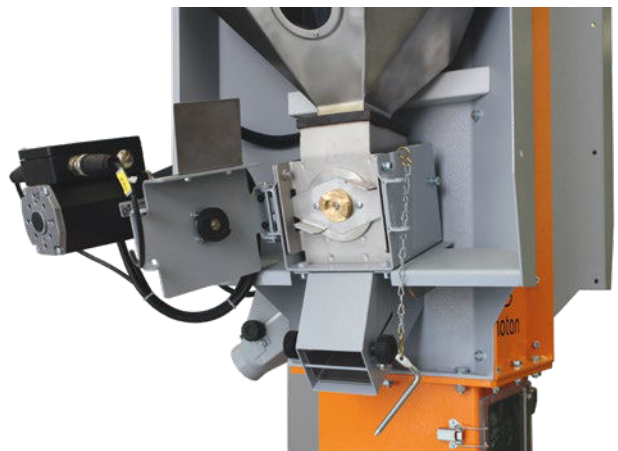
Прецизионный дозирующий шнек с подшипником с одной стороны и с байонетным замком
