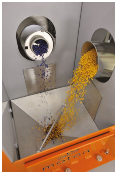
Принцип смешивания при падении
