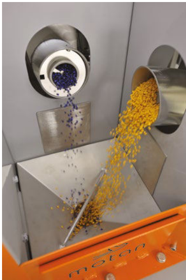
Principio di miscelazione a caduta
