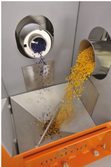
Principio de mezcla gravimétrica
