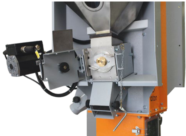
Einseitig gelagerte Präzisions-Dosierschnecke mit Bajonett-Verschluss
