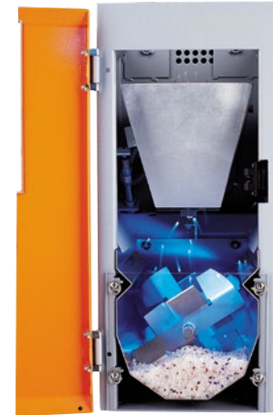
Tramoggia di pesatura con camera di miscelazione
