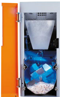
Tramoggia di pesatura con camera di miscelazione
