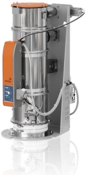
Серия METROFLOW – часть линейки продуктов motan и систем для всех стадий подготовки полимерных гранул. Гравиметрический загрузчик METROFLOW позволит переработчикам пластмасс недорого и легко автоматизировать важные области переработки. METROFLOW взвешивает каждую загрузку и оценивает результаты с максимальным отклонением 1%. Гравиметрическая регулировка производительности по подаче улучшает общий процесс управления материалом и обеспечивает полное отслеживание.
