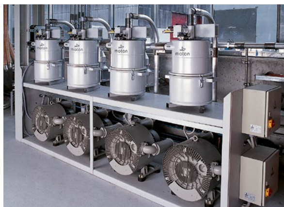
Центральные вакуумные станции
