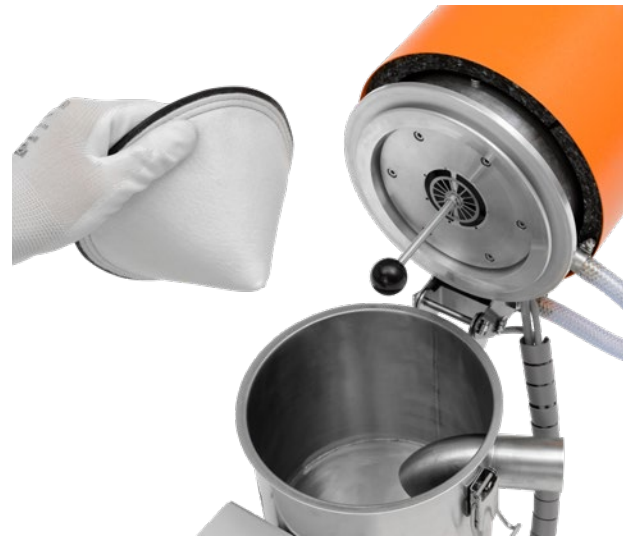
METRO SG HES cambio de filtro
